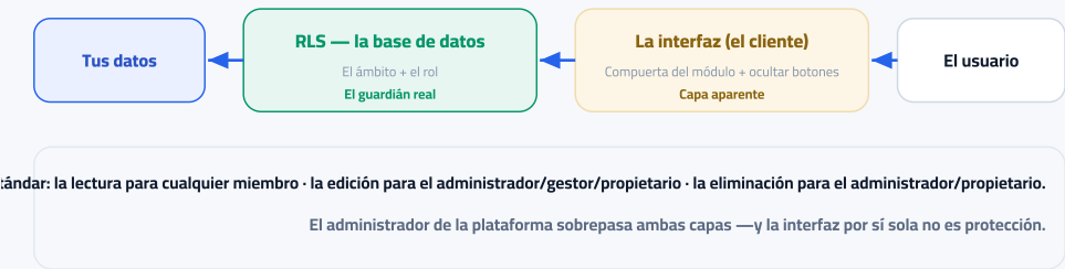
Figura 3 — Cada solicitud pasa por dos capas: la interfaz oculta y deshabilita (comodidad de visualización), y RLS en la base de datos bloquea o permite de verdad según el ámbito y el rol
