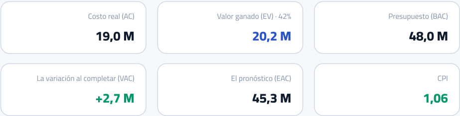
Figura 3 — Las seis tarjetas de valor ganado: el presupuesto, el ganado (y su porcentaje), el real, CPI, el pronóstico y la variación al completar
