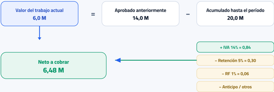
Figura 4 — Cálculo de la certificación de pago: el acumulado menos lo aprobado anteriormente = lo actual, luego sumar el IVA y descontar la retención, los impuestos y el anticipo = neto a cobrar
